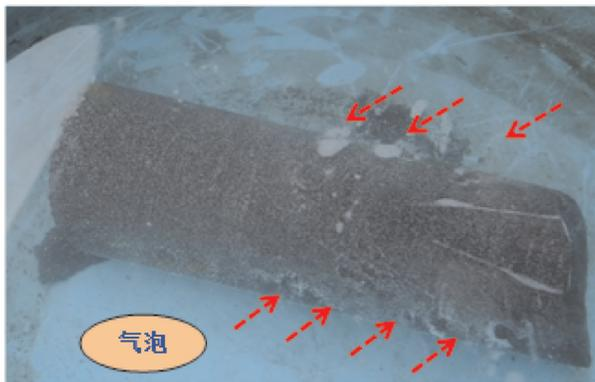
图7 龙潭组致密砂岩浸水实验
