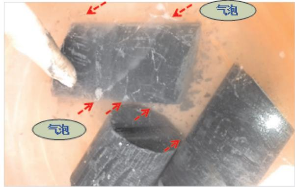
图6 大隆组富有机质页岩浸水实验
