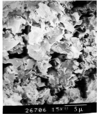
6. B1孔环河组砂岩(B1-b23) 粒表伊利石及晶间孔(4300×)
